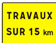
KC1 : indication de chantier important
